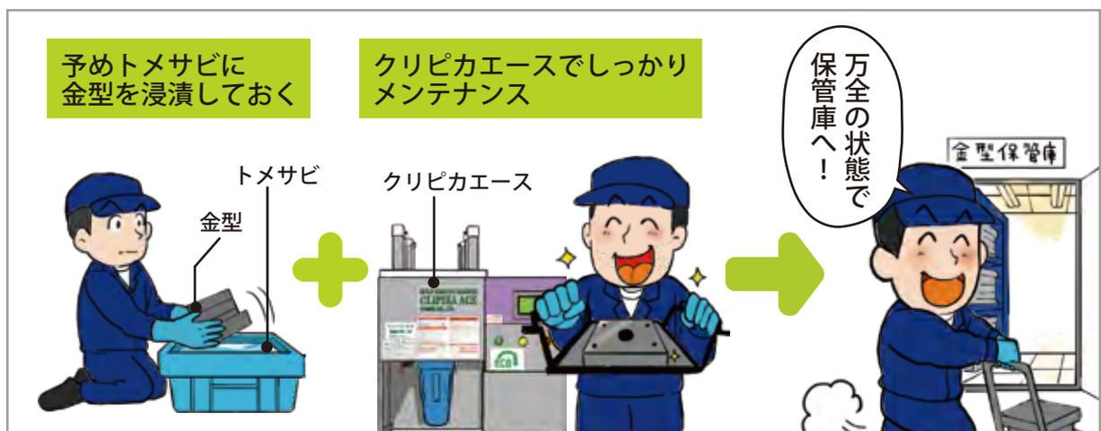
クリピカエースと併用することで、金型がさらに腐食しにくくなる!
