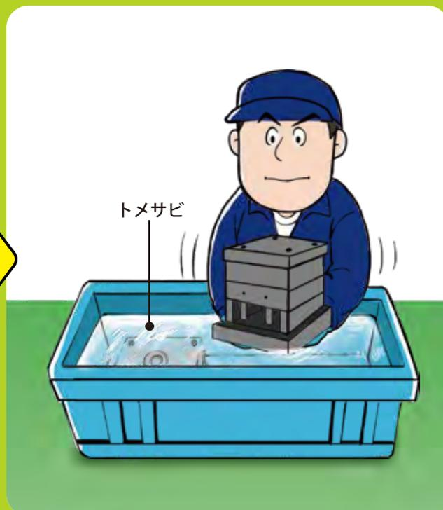
金型を漬け置いて、金型の腐食防止!
