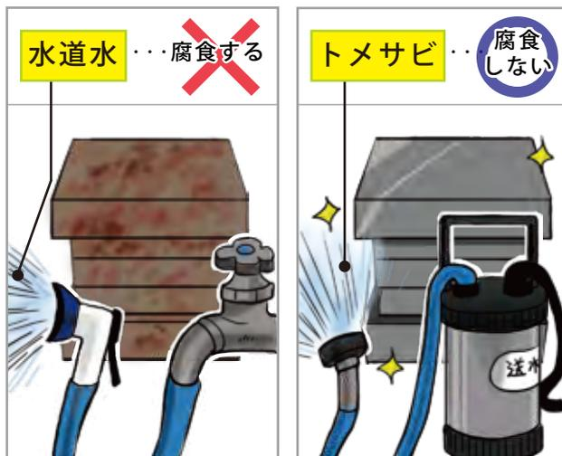
水道水の代用兼、金型の腐食防止剤!
