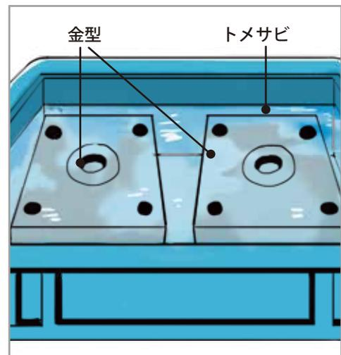
漬け置けば隙間にもトメサビが浸透し、防錆処理完了!
