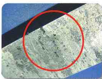
析出物発生事例 (金型表面)
