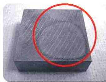
焼け発生事例 (金型表面)
