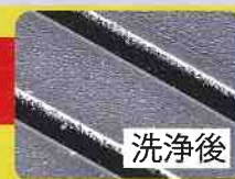
超音波エロージョン 発生事例 (金型表面)
