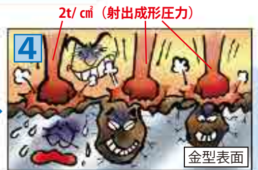
押し込まれた汚れは深く根を下ろし固着する
