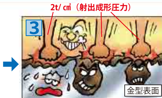
射出成形圧力で汚れが奥に押し込まれる
