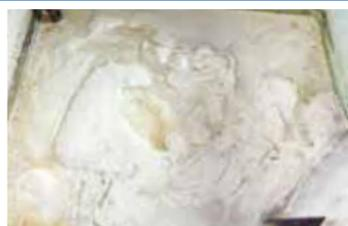
専用洗浄液槽内に白色汚泥状物が堆積した場合、専用洗浄液を新しいものに交換してください。交換せずに洗浄を続けると循環ポンプや配管が詰まり、故障の原因となります。
