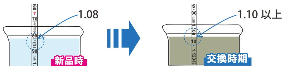
→ 未使用の専用洗浄液の比重は、専用洗浄液温が 20℃ の状態で約 1.08 に調整されていますが、使用時間に比例して比重が大きくなります。比重が 1.10 以上になると専用洗浄液の交換時期となりますので、速やかに新しい専用洗浄液と交換してください。
