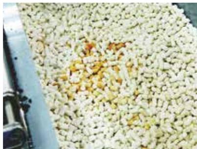
白色の酸性ガス吸収剤が変色したら、新しい酸性ガス吸収剤と交換してください。
